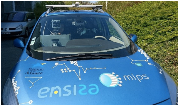
Figure 1: Véhicule ARTEMIPS équipé d'une caméra light field
