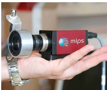
Caméra polarimétrique rapide développée au MIPS (gauche), analyse de l'état de polarisation d'une scène animée (droite)
