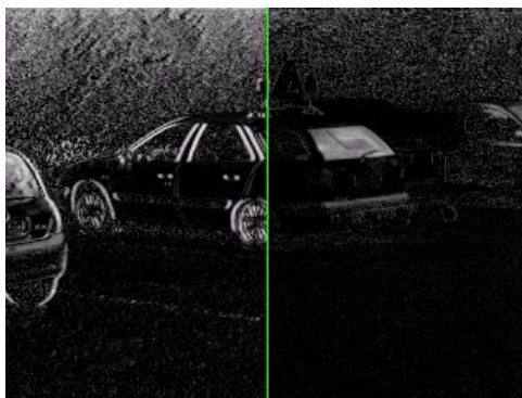
Scène en degré de polarisation : image brute (à gauche), image corrigée par un algorithme de flot optique (à droite)
